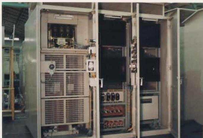
▲N型パワーキッカーが組込まれた電鉄用制御装置
