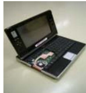
ヒートパイプ冷却ユニット実装
