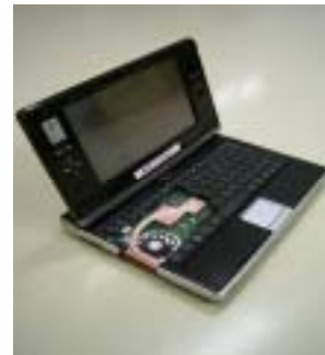
ヒートパイプ冷却ユニット実装
